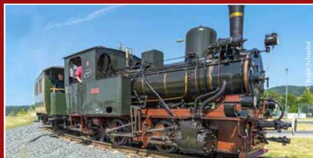
Die Dampflok 7 wurde 1919 in der damals bei Industriebahnen häufig anzutreffenden Spurweite von 900 mm für die Firma Philipp Holzmann AG gebaut. Der Eisenbahningenieur Rudolph Langeloth rettete die Lok vor der Verschrottung und führte eine grundlegende Instandsetzung durch. Hierbei wurde die Lok auch auf 1000 mm umgespurt. Dadurch passt sie heute auf das Darmstädter Schienennetz und gleicht auch in der technischen Konzeption den ursprünglich eingesetzten Lokomotiven.
