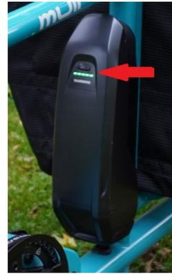
Abbildung 3: Akku mit Ein-/Ausschaltknopf und Akkustandsanzeige
