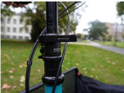
Abbildung 7: Sattelstütze mit Schnellspanner
