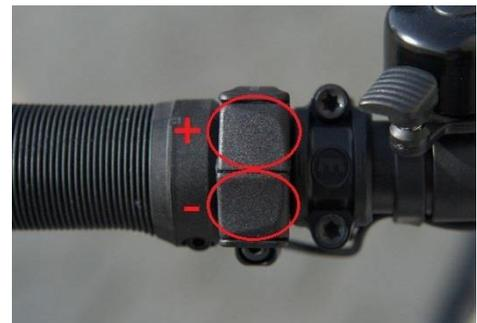
Abbildung 5: Bedienelement für die Unterstützungsstufe am linken Lenkergriff
