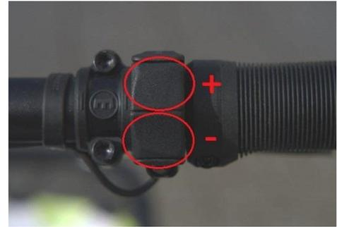
Abbildung 6: Bedienelement für die Gangschaltung am linken Lenkergriff
