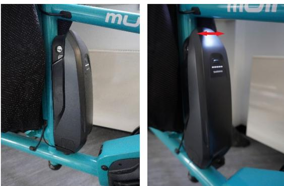
Abbildung 2: Akku in Rahmen (links) und Einrastmechanismus von Akku (rechts)
