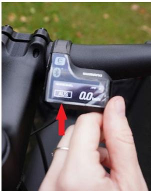
Abbildung 4: Display mit Bedienknopf
